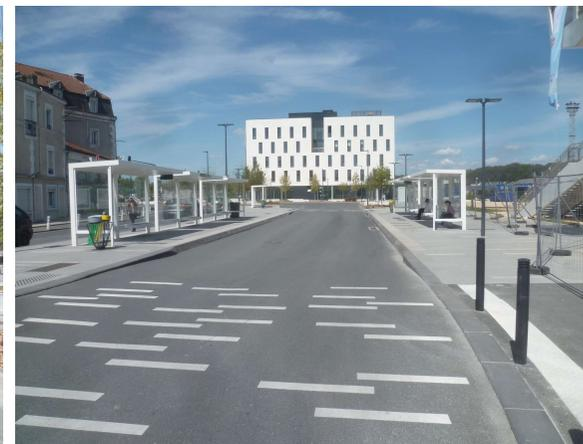
*Les aménagements cyclables (bande cyclable et couloir bus-vélo) demandent un raccordement au PEM à l'aide des trajectoires marquées au sol dans les deux sens ainsi qu'un raccordement en direction du Pôle Aliénor afin de récupérer le trottoir central dédié aux piétons et vélos*
